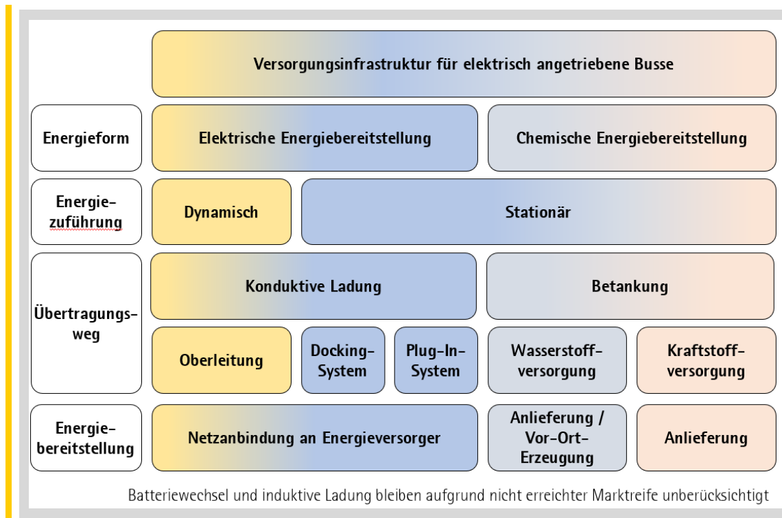
Abbildung 2.12: Versorgungsinfrastruktur für elektrisch angetriebene Busse
