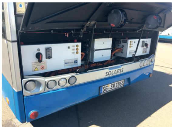
5-16 | Links: Batteriepack im Heck, Rechts: Bus mit der Oberleitung verbunden (Stadtwerke Solingen GmbH, 2019)
