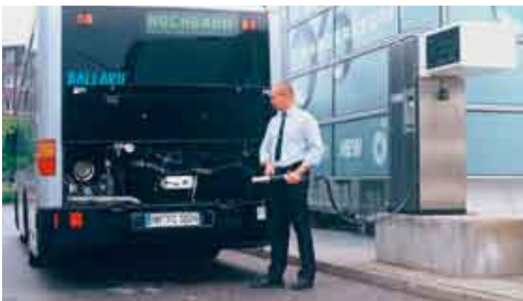
»Sauberer Bus«: Wasserstoffbus mit Tankanlage auf einem Betriebshof der Hamburger Hochbahn in Hummelsbüttel
