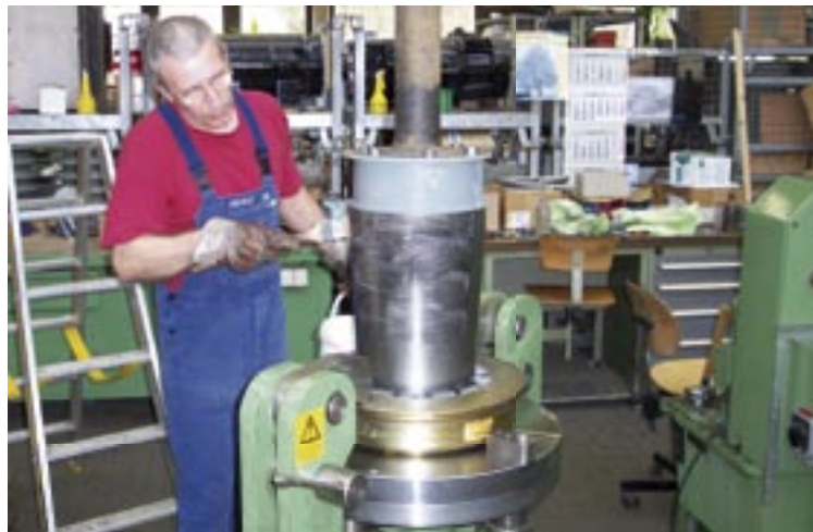
Vorbereitung eines gummigefederten Rades für das Aufpressen eines Radreifens – hier in der Schienerfahrzeugwerkstatt der Straßenbahn Darmstadt
