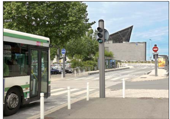
Busverkehrssystem aus einem Guss in Frankreich: Sonderfahrweg mit LSA-Beeinflussung und angepassten Haltestellen. (Foto: Bernhard E. Nickel)
